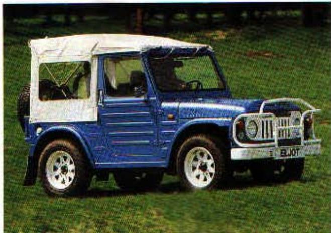
1,40 Meter paßt der Suzuki in nahezu jede Lücke und weist dementsprechend gute Geländeeigenschaften auf, die seinerzeit auch von vielen Förstern und Jägern geschätzt wurden und werden. Über ein Viergang-Schaltgetriebe mit Geländereduktion wird die Kraft des OHC-Motors auf die Hinterräder übertragen. Der Vorderachs Antrieb läßt sich per Hebel bei Bedarf zuschalten.
