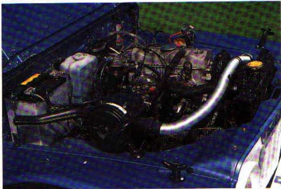
**Hochgeschützt über der Vorderachse liegt der Motor des „Eljot“.**
