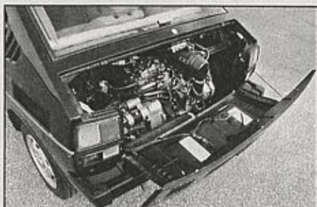
Im Heck des Suzuki-Coupé lärmt ein 50 PS starkes und 970 ccm großes Aggregat
