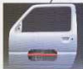
Stalen beschermingsbalken in de portieren
