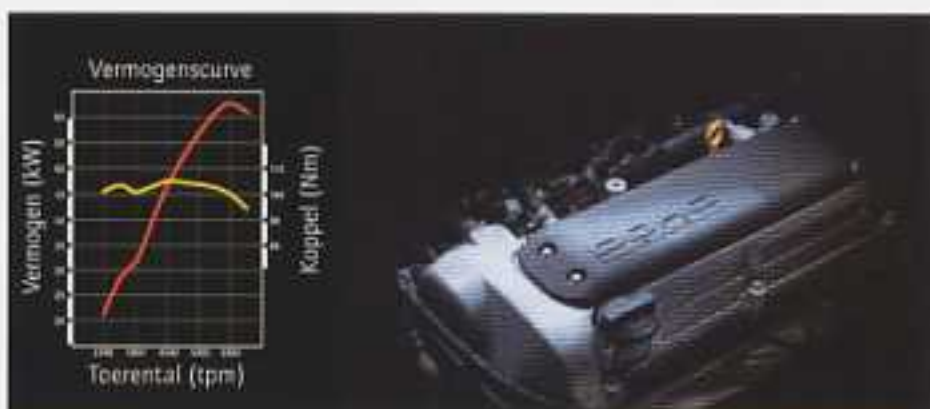
M13A viercilinder DOHC 1.328 cm 3 met VVT en 16 kleppen
